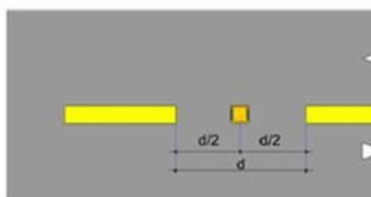
Figura: Posição da tacha junto à marca longitudinal seccionada amarela, no eixo da linha simples
